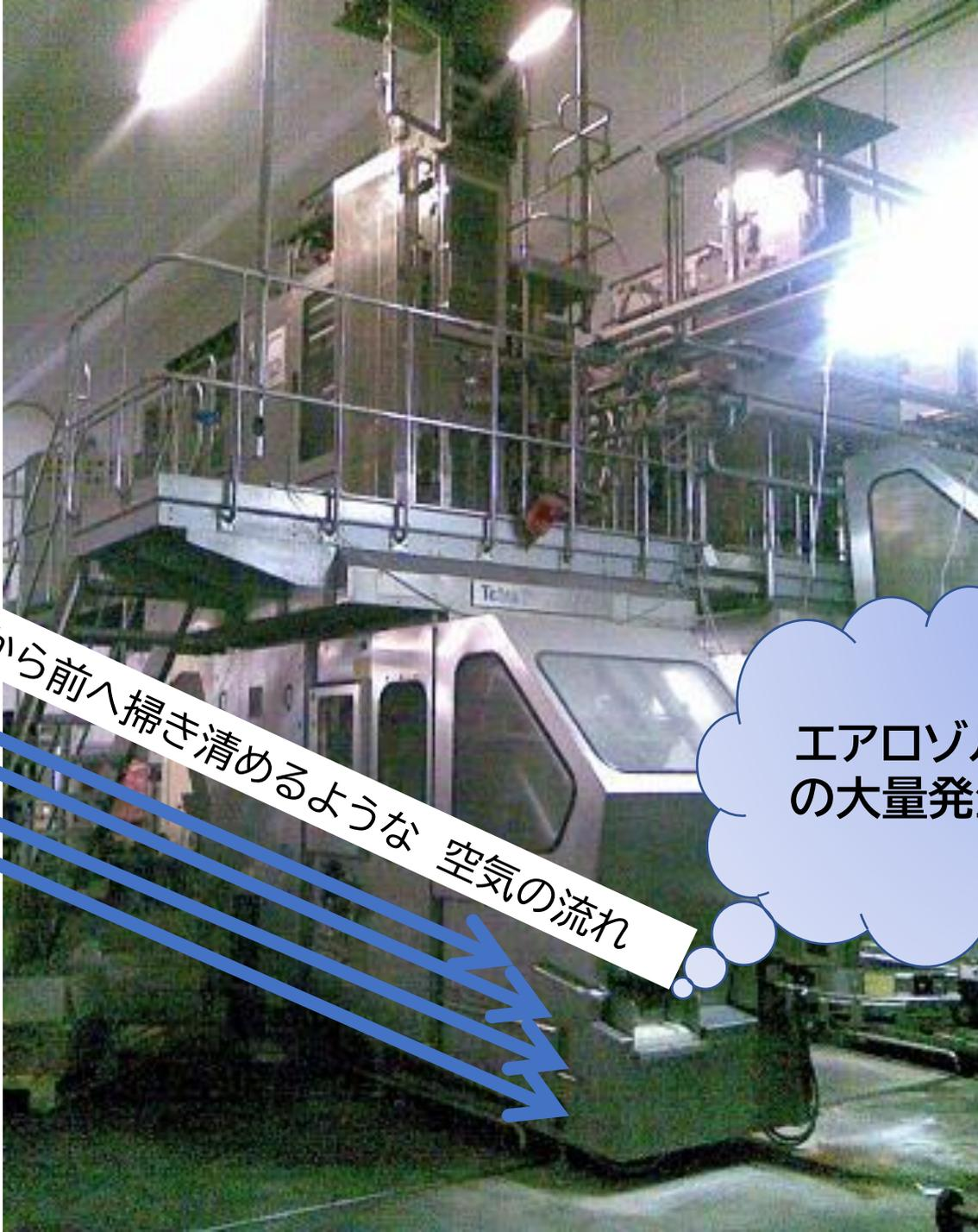
充填機後方から前へ掃き清めるような 空気の流れ
