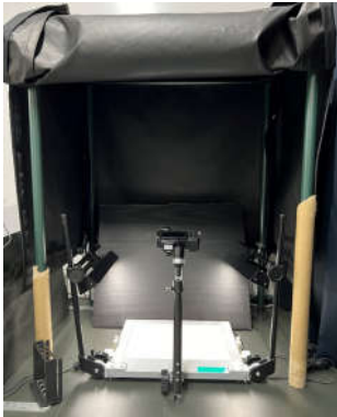
実験台上にアングルを組んで、暗幕で覆い、その中で、写真撮影装置を設置
