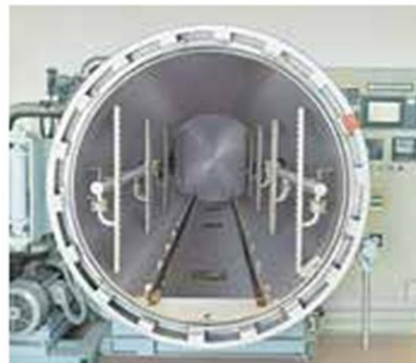
処理槽内のノズル配管
